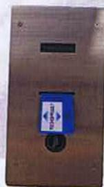
Questo sistema consente di pre-pagare un numero di corse creando un credito nella Smart card, ad ogni corsa effettuata il credito si riduce fino ad esaurimento. Sarà necessario ricaricare la Smart Card per poter utilizzare nuovamente l'ascensore.
